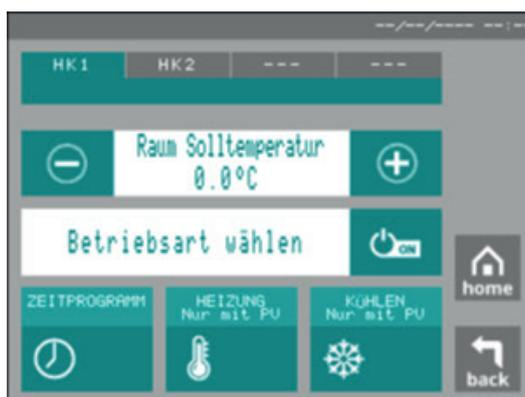
Wurde im Menü **PV** für diesen Heizkreis die Option **NUR HEIZEN MIT PV** oder **NUR KÜHLEN MIT PV** gewählt, ist dies durch den Hinweis „**NUR MIT PV**“ ersichtlich. Dies bedeutet, dass beispielsweise beim zweiten Heizkreis die Kühlung nur aktiviert wird, wenn genug PV Überschuss vorhanden ist. Diese Einstellung muss aber zuerst im Kundenmenü unter **PHOTOVOLTAIK -> ZONE** eingestellt werden.
