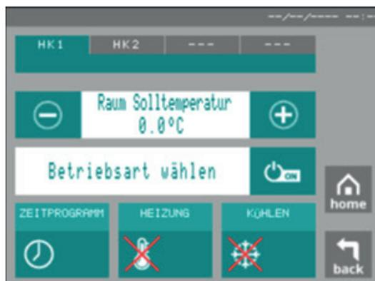
Ist der Menüpunkt HEIZUNG oder KÜHLUNG mit einem Roten Kreuz versehen, so wurde diese Funktion über die Fachmannebene oder über die Kundenebene bei Funktionen deaktiviert. Dies bedeutet, dass für diesen Heizkreis beispielsweise das Kühlen gesperrt ist und zuerst freigegeben werden muss. Diese Funktion ist unabhängig von den verschiedenen Heizkreisen.
